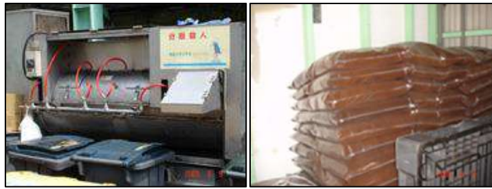
圖 3.1.1-4 日本橫濱處理廠之進料口設備與飼料成品堆放情形
