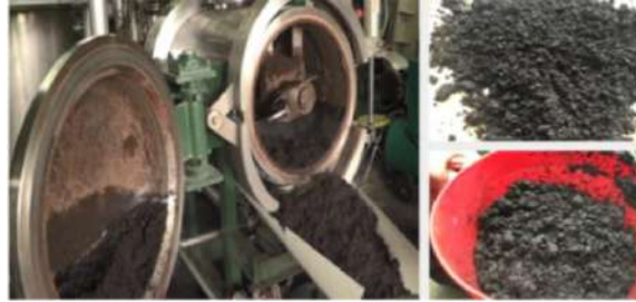
圖 3.1.1-19 高溫霧化水解系統
