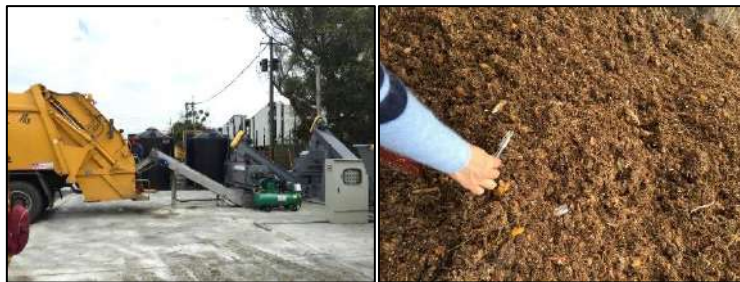
圖 3.1.2-2 雲林縣高效脫水設備及廚餘脫水後成品狀況
