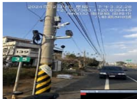
▲ 高噪音熱點路段架設聲音照相 科技執法設備
