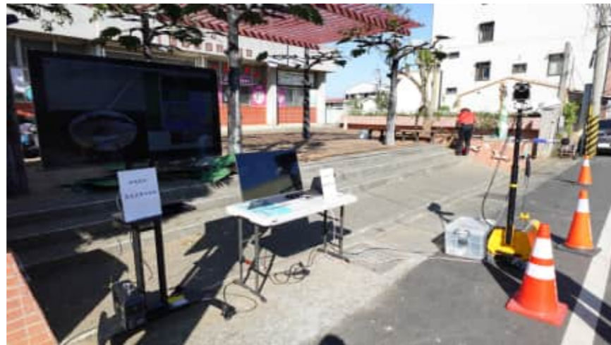
▲ 高噪音熱點路段架設聲音照相 科技執法設備
